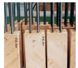
Eprouvettes d'essais de qualification de l'assemblage par tiges filetées collées
