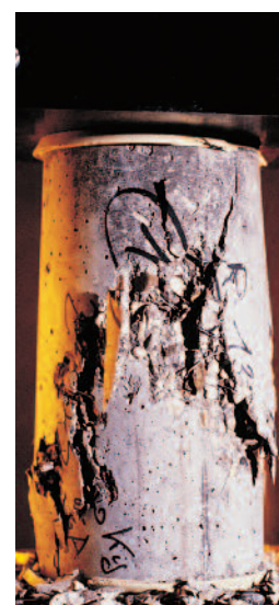
Rupture de béton fibré
