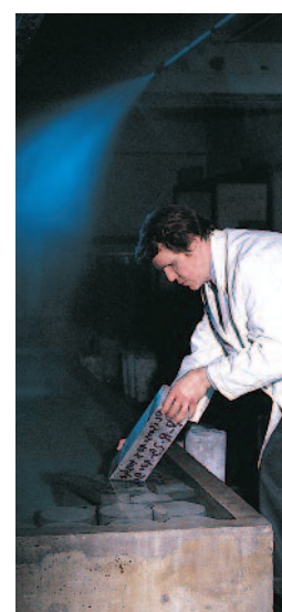
Conservation d'éprouvettes en ambiance particulière (eau de mer)
