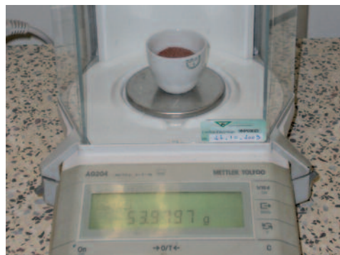
mesure de teneur en eau sur tamis moléculaire
