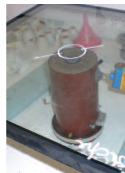
Mesure du point de Rosée sur vitrage isolant
