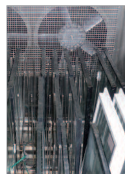
Essai de vieillissement climatique sur vitrage isolant
