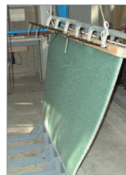
Essai statique sur garde corps vitré
