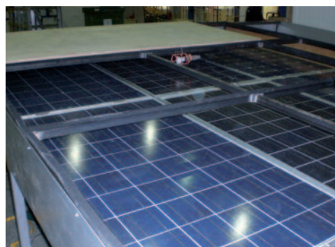
Essai de système PV intégré au bâti
