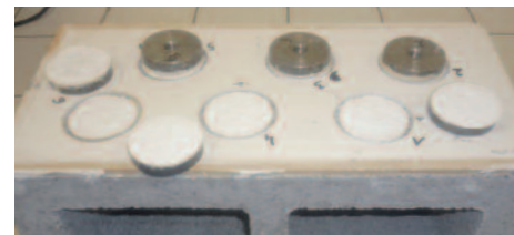
Essai d'adhérence par arrachement en traction directe
