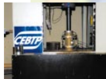
Mesure de module sur sol traité
