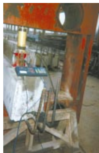
Essai de chargement d'une poutre
