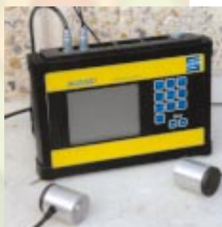
Auscultation sonique d'un voile béton
