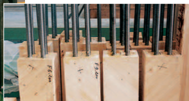
Détail : éprouvettes d'essais de qualification de l'assemblage par tiges filetées collées.
