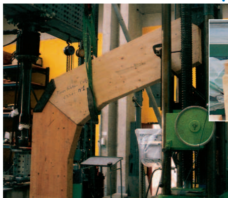
Détail : éprouvettes d'essais de qualification de l'assemblage par tiges filetées collées.
