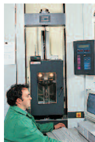
Dynamomètre équipé d'une chambre (température - 70°C à +250°C).
