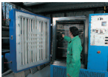
Enceinte climatique automatique avec cycles U.V./température/humidité.
