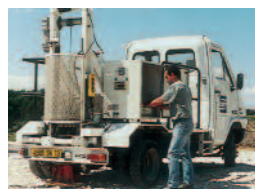
Contrôle de la portance des plates-formes par essai de plaque dynamique (multiplac, brevet CEBTP SOLEN-Colas)
