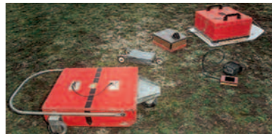
Gamme des antennes Radar 200 MHz à 14 Hz permettant une investigation de 0 à 10 m selon le contexte géologique.
