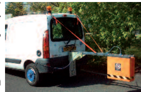
Mesure de l'épaisseur d'enrobé (par méthode radar).
