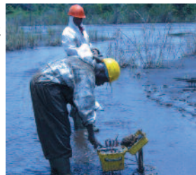
Étude hydrogéologique (par méthode électrique).
