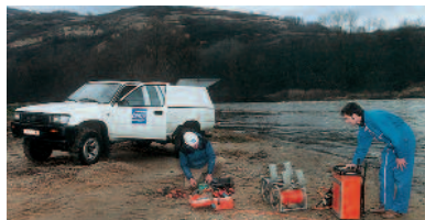
Prospection sismique réfraction terrestre et aquatique (Laboratoire Abem Terralo 24 traces).
