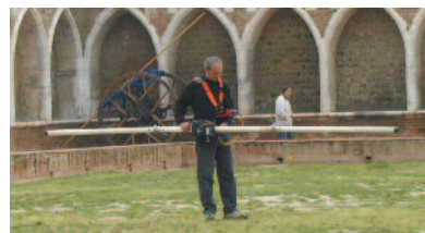
Prospection électromagnétique (appareil Géonics Type Em 31d).
