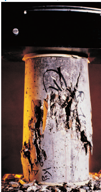
Rupture de béton fibré.
