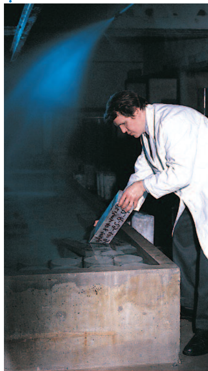
Conservation d'éprouvettes en ambiance particulière (eau de mer).
