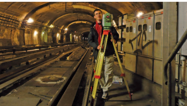
Auscultation de tunnel
